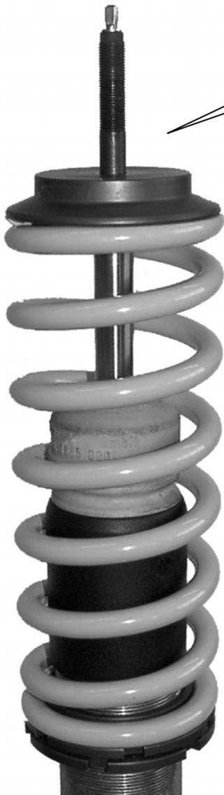
Das originale Stützlager auf das Federbein wie im Bild aufsetzen und verschrauben. Anzugsdrehmoment Kolbenstangenverschraubung 25 Nm.
