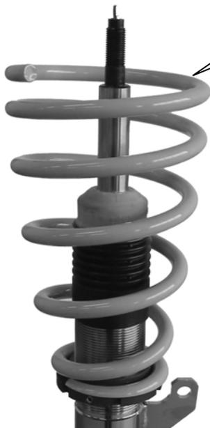
Original Federteller mit Gummiunterlage und serienmäßiger Unterlegscheibe auf die Feder aufsetzen. Wie im Bild dargestellt, muss der Federauslauf an der dafür vorgesehenen Stelle des Federtellers anliegen.
