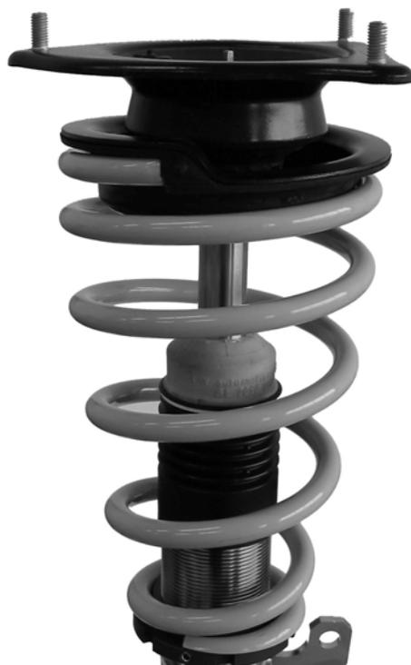
Original Stützlager auf das Federbein aufsetzen und verschrauben. Anzugsdrehmoment der Kolbenstangenverschraubung 50 Nm.
