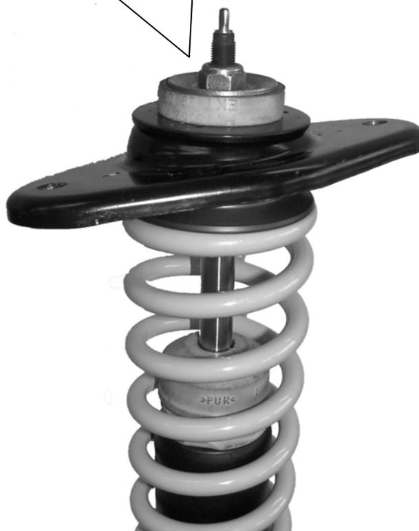
Das Serienmäßige HA Stützlager hat eine Kennzeichnung R = Rechts bzw. L = Links bitte beachten Sie ,dass dieses jeweils auf der richtigen Fahrzeugseite montiert wird.
